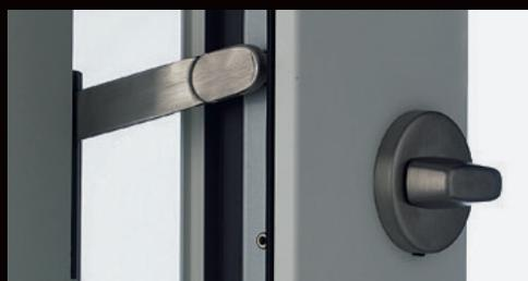
Le blocage de porte TSH tient lieu de limitation d'ouverture. Il est actionné depuis l'extérieur par la serrure principale (aucun cylindre extérieur). L'actionnement depuis l'intérieur est assuré par un bouton rotatif.
